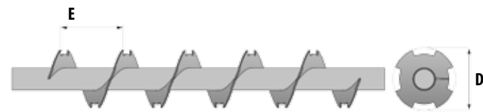
Pióro z korbami do mieszania surowca wyciętymi od zewnątrz
